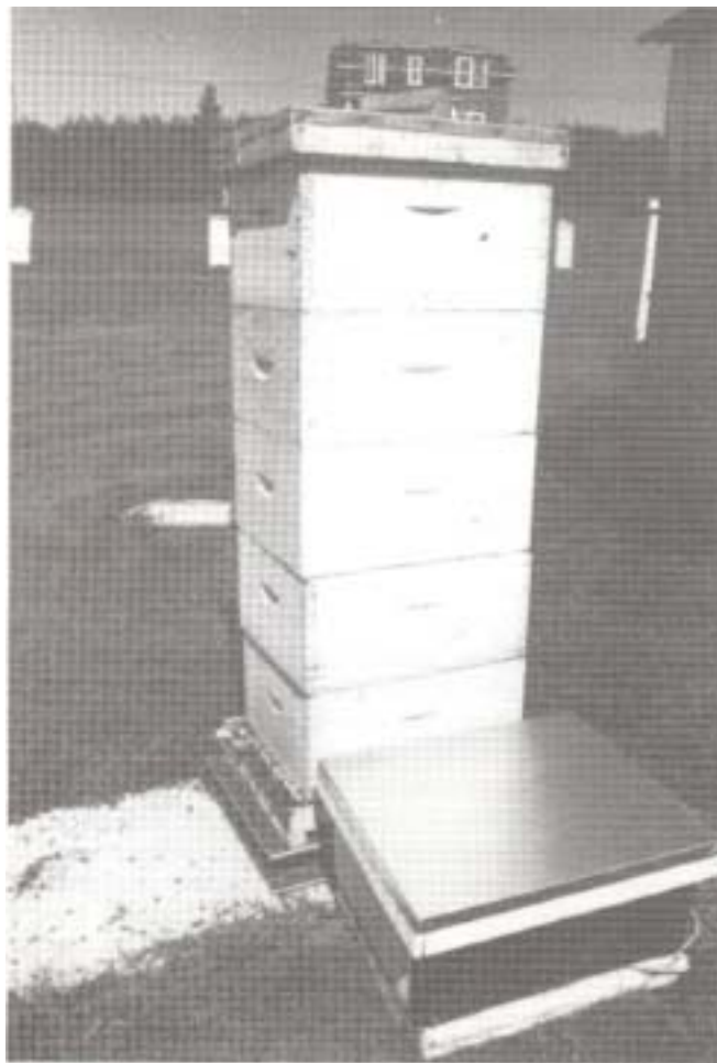
Un activimètre utilisé sur une ruche standard. La partie compteur est dissimulée dans une hausse de 240 mm.
